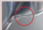
Rychlost posuvu: Doba obrábění: 1 h 38 min 36 s Mikrorýhy na povrchu.
